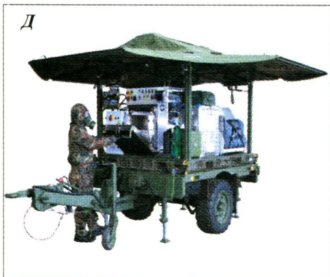
Структурные элементы системы специальной обработки ДСО: A – основной модуль спецобработки ВВТ (S1); Б – вспомогательный модуль (S2); В – модуль санитарной обработки личного состава и снаряжения; Г – модуль обработки радиоэлектронного и электротехнического оборудования (DMSE); Д – модуль для спецобработки внутренних отсеков военной техники, фортификационных сооружений (DMSI); Е – модуль водоснабжения
