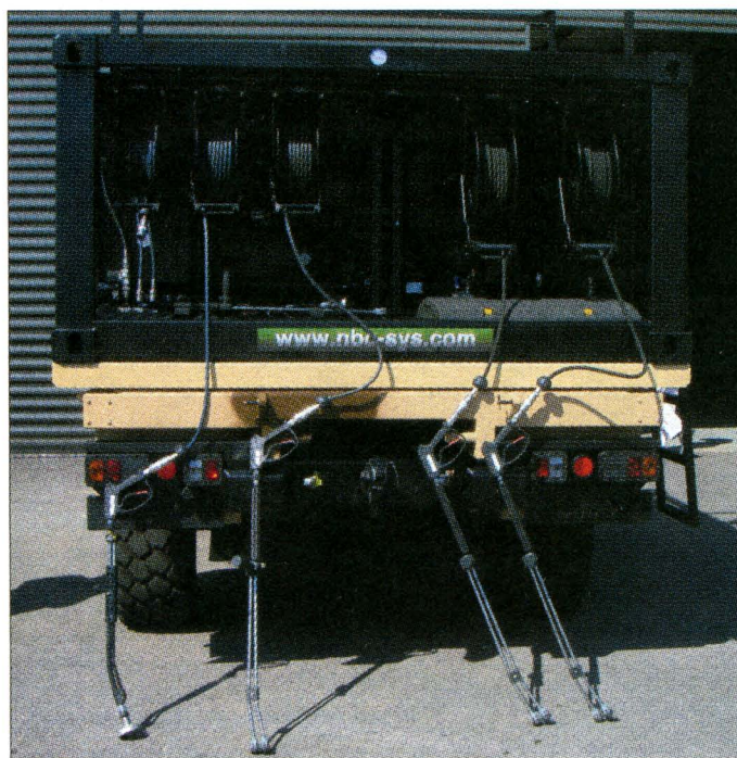
Общий вид модуля «Рбц» (сверху) и вид сзади (видны барабаны с развернутыми рукавами)
